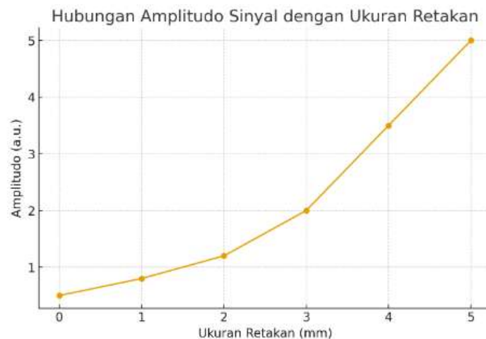
Gambar 2. Grafik hubungan amplitudo sinyal dengan ukuran retakan.
